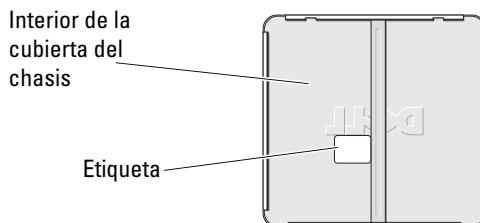
Debe ver una de las siguientes etiquetas en el interior de la cubierta del chasis:
